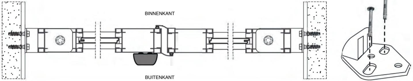
**ONDERHOUD POORT:** Grondschroeven en scharnieren minimaal 2x per jaar invetten met teflon spray type WD40.
