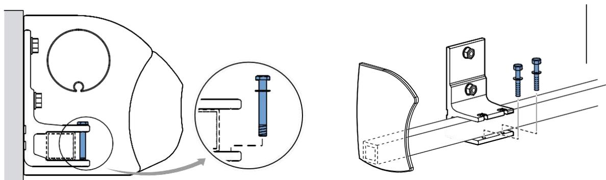
fig. 2.3 Pose de boulons de blocage
