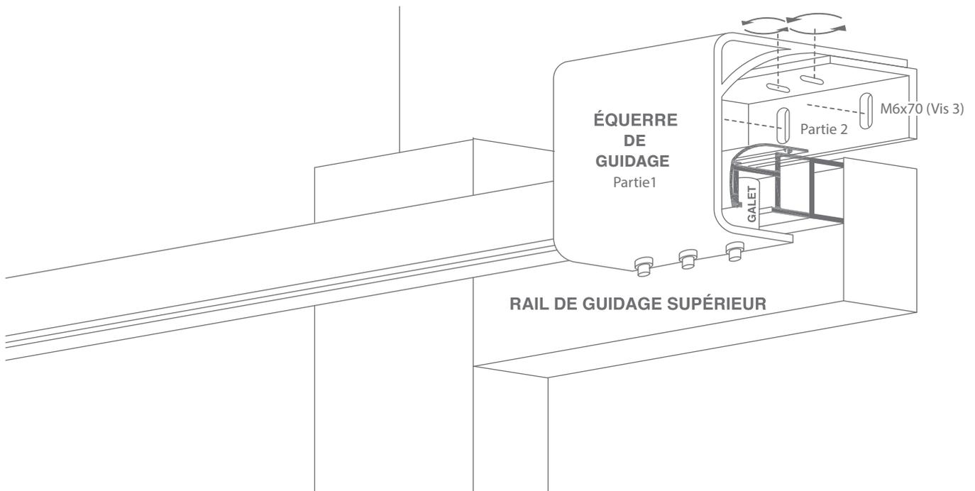
Pour déterminer les trous de fixations de l'équerre de guidage (côté refoulement):
