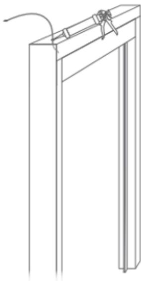
Le boîtier de l'écran a également besoin d'une protection supplémentaire. Siliconez l'ouverture et collez soigneusement du ruban adhésif comme indiqué dans les images ci-dessous.
