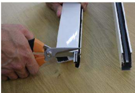
Zorg ervoor dat de uiteinden aan 1 zijde gelijk zitten met het uiteinde van het profiel. Knijp het teveel van de borstelafdichting af.
