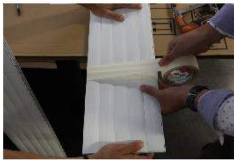
Tape de lamellen per 5 samen, zodat ze niet verschuiven wanneer deze ingekort worden.
