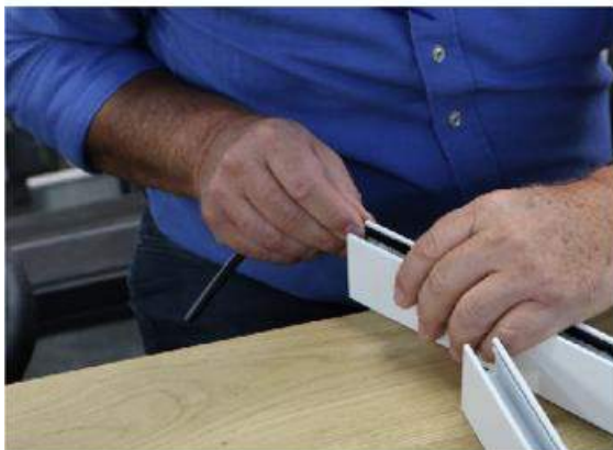
Schuif de borstelafdichting in de geleiders.
