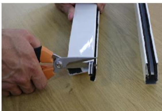
Zorg ervoor dat de uiteinden aan 1 zijde gelijk zitten met het uiteinde van het profiel. Knip het teveel van de borstelaafdichting af.
