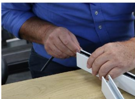
Schuif de borstelaafdichting in de geleiders.
